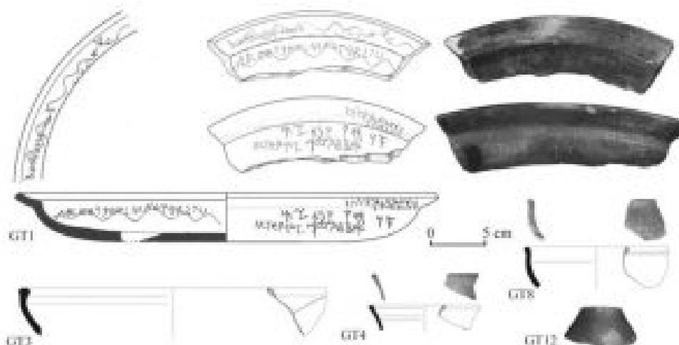
**Figura 4.** Materiales con defectos de cocción recuperados en los depósitos de colmatación del horno de Carril do Moucho (Bartolomé 2015: 374).
