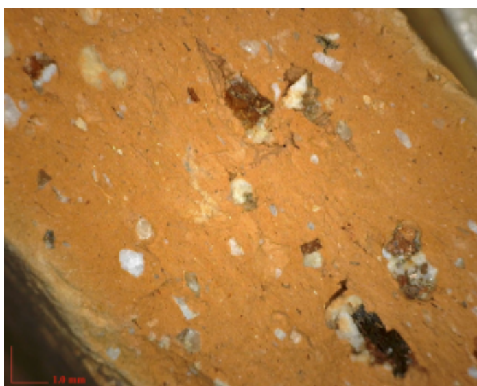
Figura 6. Pasta de las producciones menos depuradas del testar, Predicadores M5. Se aprecian las inclusiones graníticas., Foto C. Aguarod.
