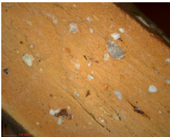
Figura 7. Pasta de las producciones menos depuradas del testar, Predicadores M1. Se aprecian las inclusiones graníticas, Foto C. Aguarod.
